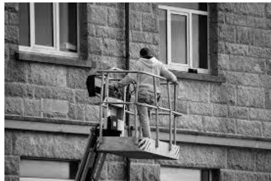
**Estructura extensible:** Estructura que está unida al chasis y soporta la plataforma de trabajo permitiendo moverla hasta la situación requerida. Está constituida por tramos, plumas o brazos, simples, telescopicos o articulados, estructura de tijera, o cualquier otra.
