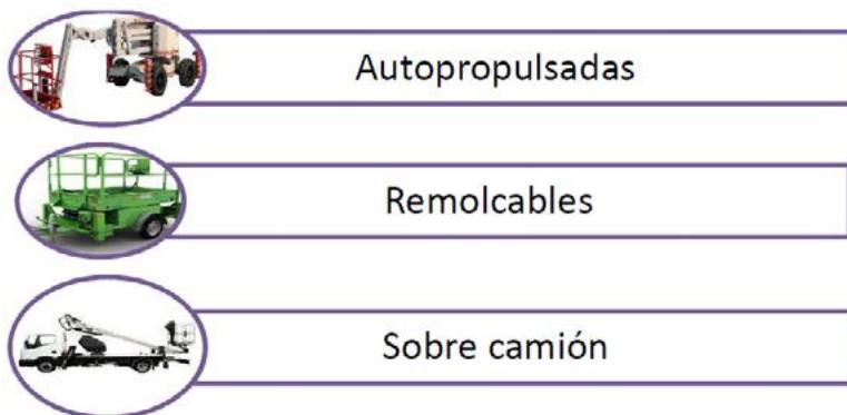
**PLATAFORMAS AUTOPROPULSADAS:** Se denomina autopropulsada, la plataforma que permite realizar los desplazamientos de translación con los brazos elevados y el usuario manipulándola desde la cesta.
