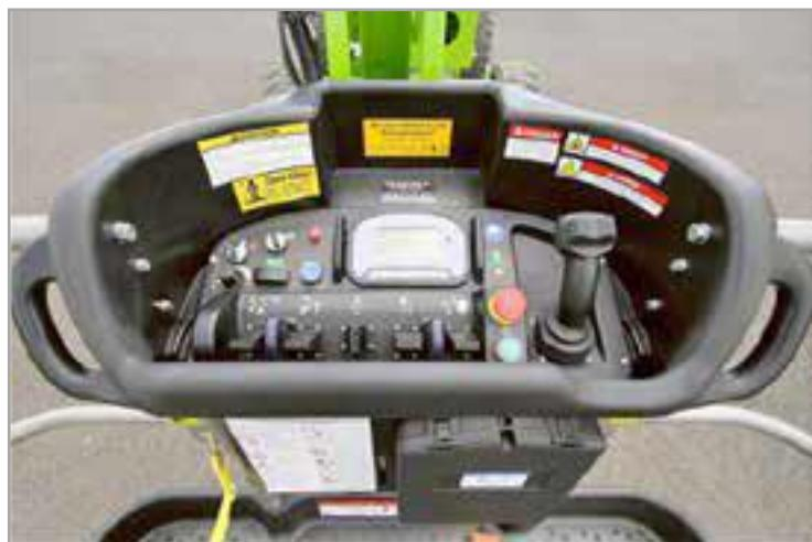
**Los mandos** deben estar diseñados de forma que no puedan ser accionados de forma inadvertida o por personal no autorizado. El ángulo de inclinación sobre el que puede trabajar la plataforma se controlará mediante el sistema de seguridad de inclinación máxima de la misma.
