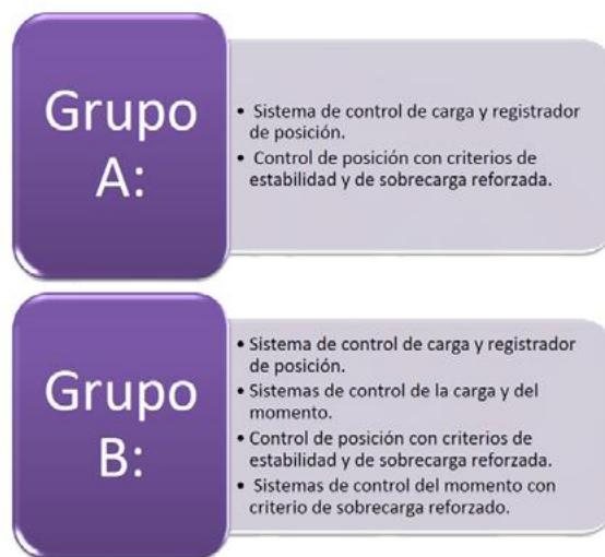
Conviene destacar que los controles de carga y de momento no protegen contra una sobrecarga que sobrepase ampliamente la carga nominal.
